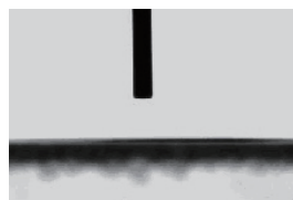
コーティング施工後 接触角: 3.3度
